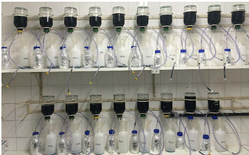
Figura 2: Aparato experimental para monitoramento da produção diária de CH 4
